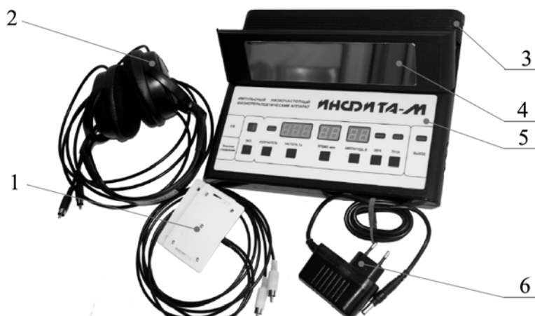
Рис. 1. Общий вид аппарата «ИНФИТА-М»: 1 – выносные пластины; 2 – отологическая приставка «ЭЛЕМАГС»; 3 – корпус; 4 – поворачивающаяся панель с зеркальным излучателем; 5 – лицевая панель; 6 – адаптер сетевой
