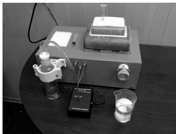
Рис. 1. Экспериментальная установка вакуумной сепарации растворов ДНК
