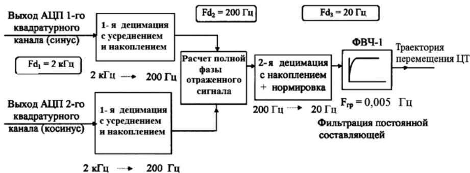
Рис. 4. Структурная схема алгоритма цифровой обработки сигнала для построения траектории ЦТ
