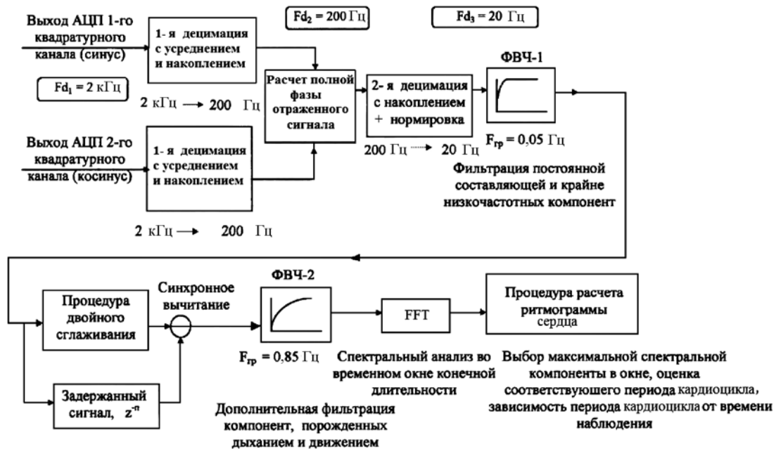
Рис. 3. Структурная схема алгоритмов программы обработки сигнала для получения ритмограммы сердца
