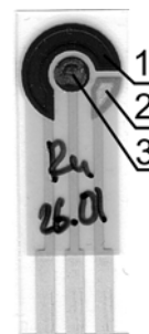
Рис. 1. Внешний вид планарного трехэлектродного датчика: 1 – графитовый противэлектрод; 2 – электрод сравнения Ag/AgCl; 3 – рабочий электрод, модифицированный оксидом рутения
