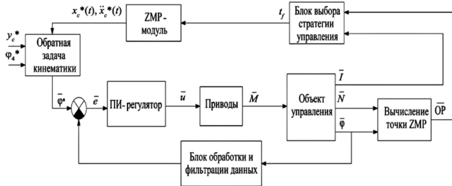
Рис. 1. Структурная схема системы автоматического управления экзоскелетом для реабилитации нижних конечностей человека
