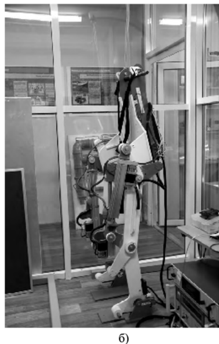
Рис. 3. Экзоскелет: а) структурная схема экзоскелета; б) общий вид экзоскелета для реабилитации; 1 – бедро; 2 – голень; 3 – ступня; 4 – корпус; 5 – поверхность
