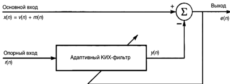
Рис. 2. Структурная схема адаптивного фильтра подавления шумов (пояснения – в тексте)
