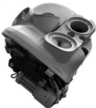
Рис. 3. Имплантируемый модуль насоса полностью искусственного сердца «Carmat» [3]
