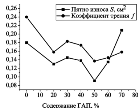
Рис. 3. Зависимость коэффициента трения и пятна износа от содержания наполнителя
