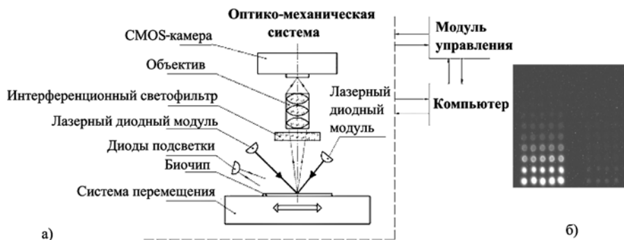
Рис. 2. Получение изображения с использованием разработанного анализатора: а) опико-механическая схема флуоресцентного анализатора; б) фрагмент изображения, полученный с его помощью
