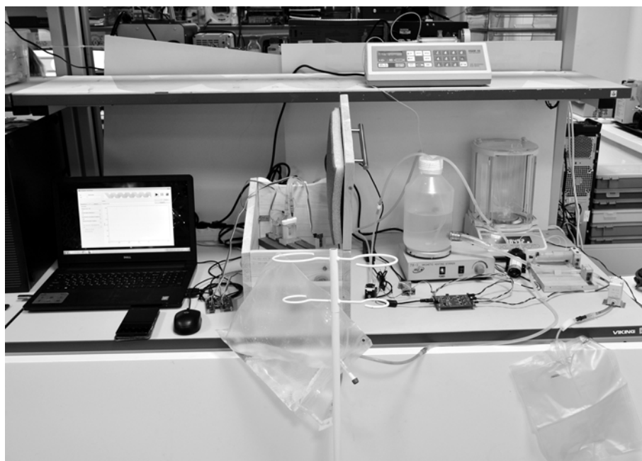
Рис. 2. Общий вид стенда проверки технических характеристик аппарата «искусственная поджелудочная железа»
