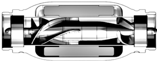
Рис. 1. Конструкция роторного насоса крови в составе аппарата вспомогательного кровообращения носимого «Спутник»
