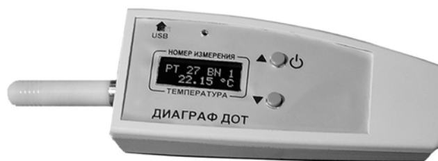
Рис. 3. Головка прибора ДОТ: 1 – защитный колпак датчика; 2 – датчик; 3 – дисплей; 4 – кнопки управления; 5 – корпус
