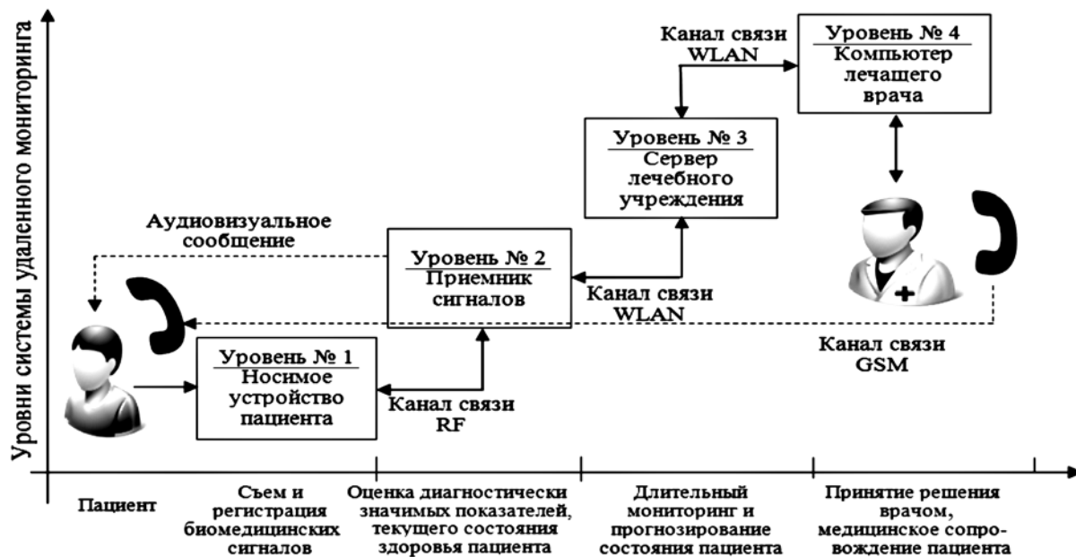
Рис. 1. Структура системы удаленного мониторинга
