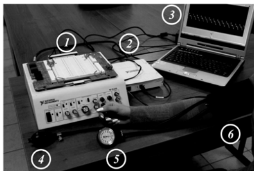
Рис. 1. Общий вид установки для регистрации пульсовой волны: 1 – лабораторная настольная станция «NI ELVIS»; 2 – DAQmx; 3 – ноутбук; 4 – резиновая груша; 5 – манометр; 6 – манжета со встроенным датчиком давления
