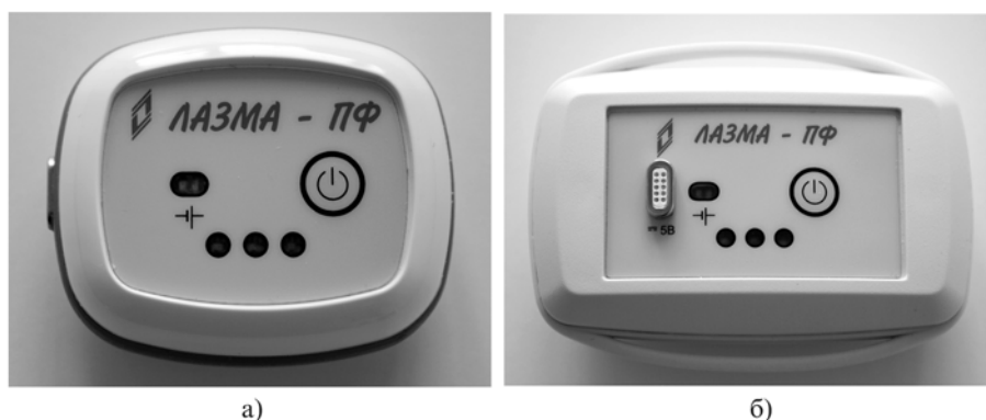
Рис. 1. Модификации портативных (носимых) анализаторов «ЛАЗМА ПФ»: а) анализатор с функцией диагностики микрогемодинамики (метод ЛДФ); б) анализатор с возможностью совместного контроля микрогемодинамики (метод ЛДФ) и биомаркера окислительного метаболизма (способ ФС)
