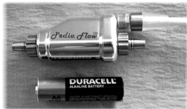
Рис. 2. АВК PF: сравнение размеров имплантируемой части насоса с батареей типа AA
