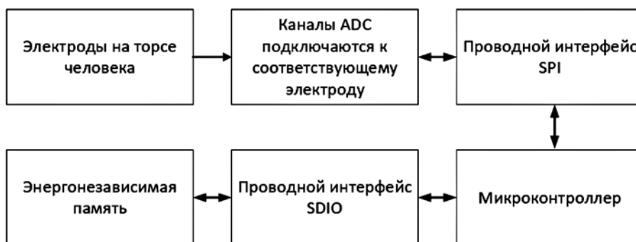
Рис. 3. Схема модуля регистрации множественных отведений ЭКС
