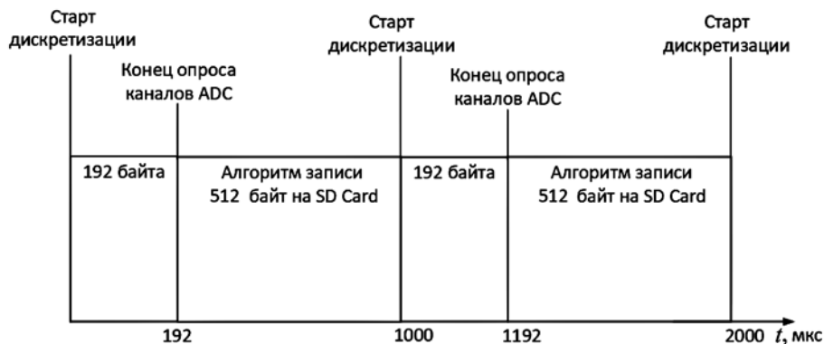
Рис. 6. Временная диаграмма для одного цикла опроса ЭКС множественных отведений
