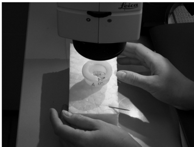
Рис. 2. Установка полиэтиленового вкладыша для работы со стереомикроскопом «Leica M125»
